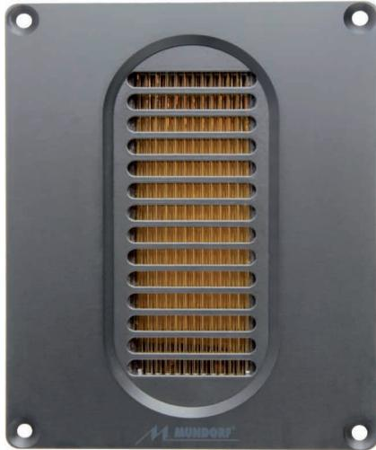
High End AMT für 2-Weg Systeme. Der 25CM1.1 verbindet eine starke vertikale Bündelung mit einem breiten horizontal Abstrahlverhalten. Ideal für schallharte Böden und Decken. Gleichzeitig ist es der AMT mit der niedrigsten Übernahmefrequenz.
