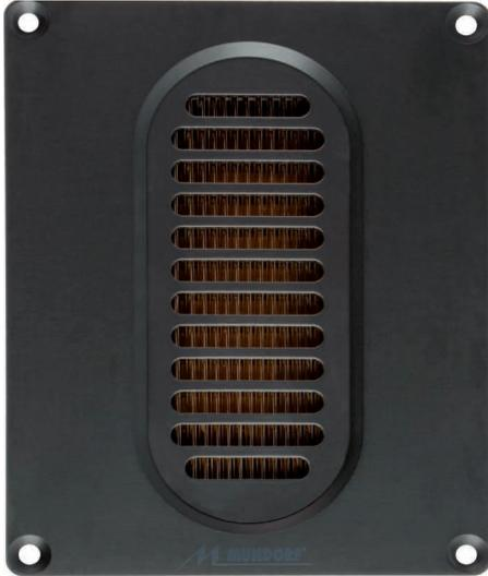
Dieser Dipol ist optimiert für den Einbau in eine Schallwand. Mit Resonanzlinearisierung ist eine Übernahmefrequenz von 2 kHz möglich. Mit einer Empfindlichkeit von 93 dB bereits für Röhrenfreunde geeignet.
