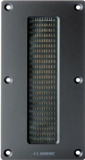
Aufgrund seiner patentierten U-förmigen Polplattengeometrie baut das System sehr schmal und ist optimal für Center-Speaker geeignet. Besonders ist auch die Übernahmefrequenz von 1800 Hz und sein Wirkungsgrad von 99 dB.
